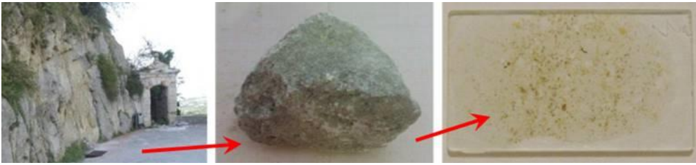
Fig. 6 - Punto di prelievo, campione prelevato, sezione sottile camp. 4
