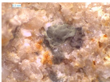
Fig. 8. Muestra CCPA09: grano de glauconita (imagen de lupa, 35x).
