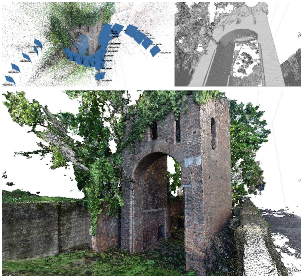
Fig. 6 – Modellazione SfM di Porta Calcinara, cinta muraria gotica, da acquisizione fotografica.
